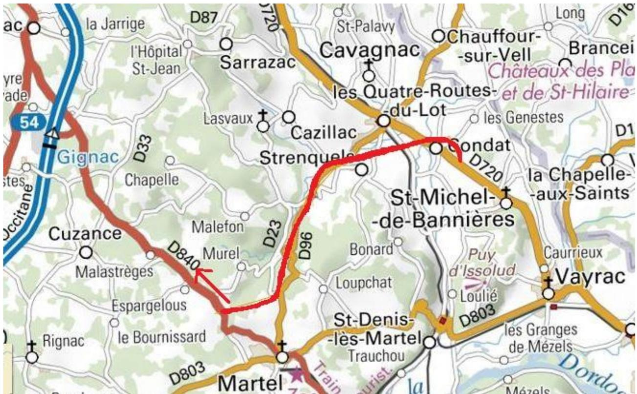
Sur les 9,7 km du T3, 16 carrefours dont quatre giratoires, quatre carrefours en croix et huit carrefours en T seront rétablis ou aménagés, 6 ouvrages de franchissements et ouvrages hydrauliques principaux et 24 ouvrages hydrauliques supplémentaires seront créés, 713 000 m<sup>3</sup> de terres et déblais seront décapés.
